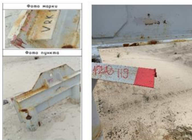
Рисунок 2. Внешний вид деформационных марок
